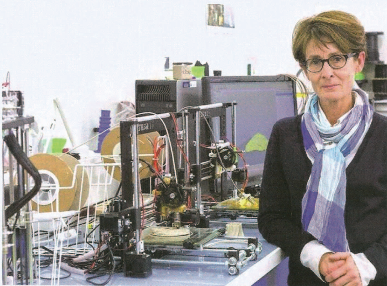
Martine Le Lu devant des imprimantes 3D équipées de filament fabriqué avec la poudre de coquilles d'huître Ostreocal. © Usine de Kervellerin
